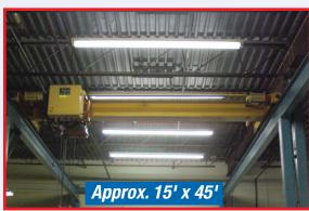
**CRANE SYSTEM, 3 TON KONE HOIST**
