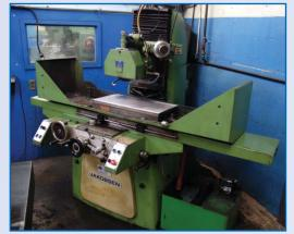
**JAKOBSEN** 12"X24" AUTOMATIC HYDRAULIC SURFACE GRINDER, MODEL SJ30
